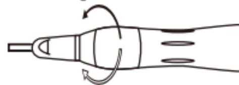
In geval van overmatige belasting door een defecte boor met een omwentelingssnelheid van 40 000 tpm zullen de kogellagers snel beschadigd raken. Plaats de boor altijd volledig in de boorhouder. Dit voorkomt dat de boor uit de houder schuift en/of de kogellagers beschadigt. Gebruik het apparaat nooit zonder boor als de boor niet veilig is geplaatst of als de vergrendelingsring van de boor niet in de juiste positie zit.
