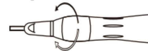
Übermäßige Belastungen durch defekte Bohrer beim Drehen mit 40.000 U/Min führen schnell zu Schäden an den Kugellagern.
