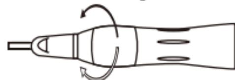
Les charges excessives générées par une fraise défectueuse tournant à 40 000 tr/min endommageraient rapidement les roulements à billes.
