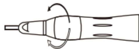
Las cargas excesivas que producen las fresas defectuosas que giran a 40 000 rpm dañan los rodamientos con rapidez.
